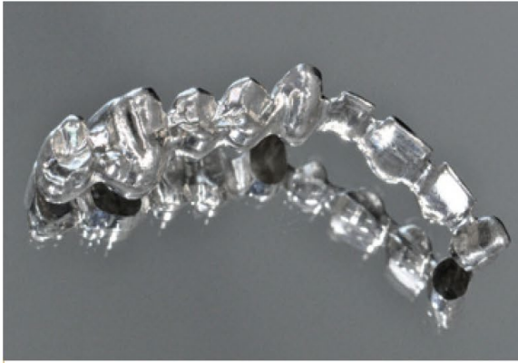
Abb. 17: Durch das Fräsen sehr homogen ausgearbeitete Oberfläche.
